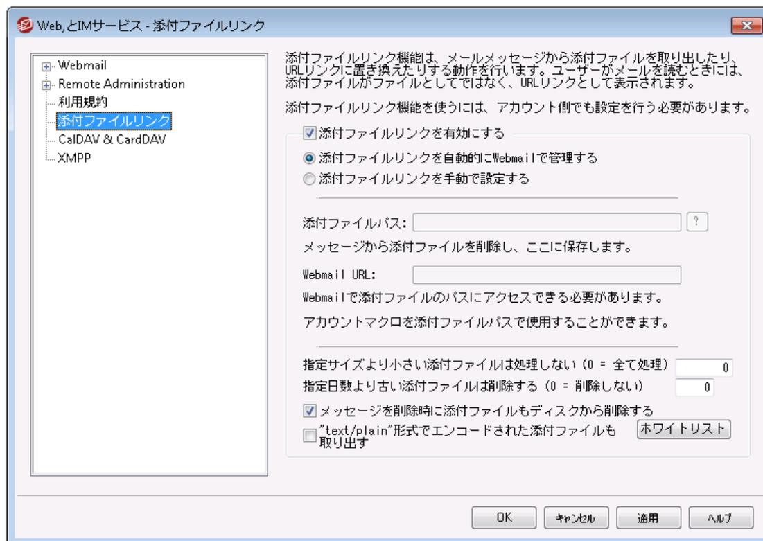
添付ファイルリンク(設定 ≫ WebとIMサービス ≫ 添付ファイルリンク)は、MDaemonで受信メールメッセージから添付ファイルを取り除き、指定された位置に保存し、対象ファイルを各メールでURLに置き換える機能です。受信者側は、メールの中のリンクをクリックする事で、添付されていたファイルをダウンロードできます。この機能により、大きなサイズの添付ファイルが付いたメールをユーザーが受信する際や、そういったメールを含むメールフォルダを同期する際の処理速度を大きく向上させる事ができます。
