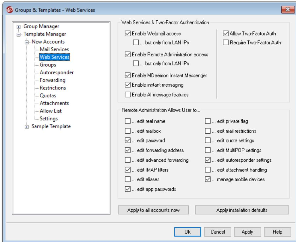
テンプレートのこの画面はアカウントエディタのウェブサービス<sup>[655]</sup>機能と関連しています。テンプレートがこのアカウント設定をコントロールする<sup>[722]</sup>と設定されていた場合、テンプレートを使用するグループ<sup>[713]</sup>に所属するアカウントのウェブサービスオプションはこの画面の設定でコントロールされます。
