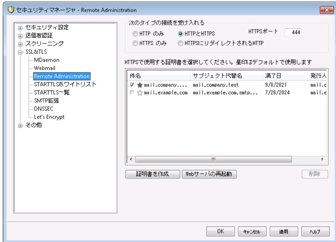
MDaemonに搭載されているウェブサーバーはSecure Sockets Layer (SSL)プロトコルに対応しています。SSLとは、サーバー/クライアント間のウェブコミュニケーションを安全に行うための標準規格であり、サーバー認証、データ暗号化、TCP/IP接続用に追加のクライアント認証などの機能を提供しています。ほとんどのブラウザでは(HTTP over SSLのような)HTTPSに対応しているため、サーバー側に正しい証明書をインストールするだけで、クライアントはSSL機能を利用できるようになります。
