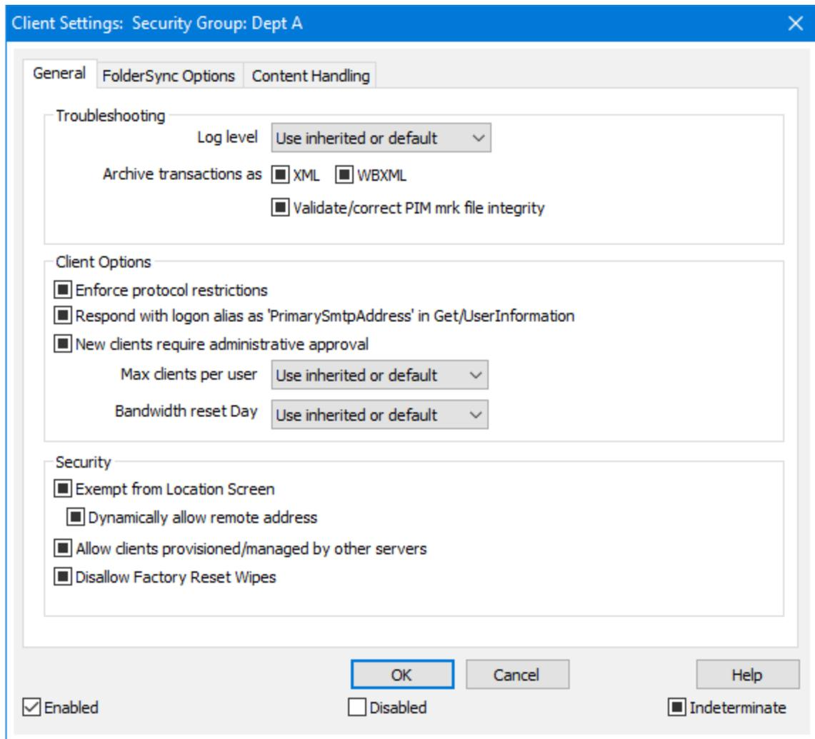
デフォルトで各グループのクライアント設定はユーザーのドメインクライアント設定<sup>[189]</sup>を継承して設定されます。グループ設定を変更すると、変更箇所はアカウントが属したグループのドメイン設定を上書きします。グループクライアント設定を特定のグループメンバーやデバイスへ適用しない場合は、アカウント<sup>[407]</sup>、クライアントタイプ<sup>[432]</sup>、クライアント<sup>[416]</sup>向けのクライアント設定を変更する事で、グループ設定を上書きしてください。
