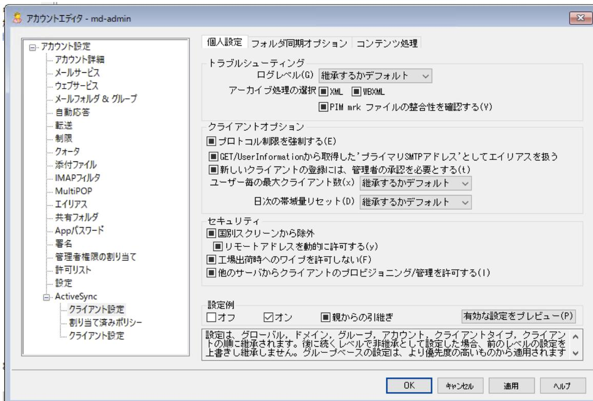
ここではアカウントに関連付けられたActiveSync クライアント設定が行えます。デフォルトで各オプションは所属するドメインの設定値を引き継ぎます。ここで設定はドメイン設定<sup>[391]</sup>を上書きします。また、[クライアント](#)<sup>[702]</sup>の設定オプションを使うと、特定のクライアントにおいては、アカウントレベルでの設定値を上書きします。
