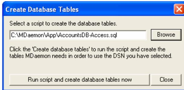
7. スクリプトを実行し、データベースのテーブルを作成します。をクリックして**OK**をクリックして閉じるをクリックします。
