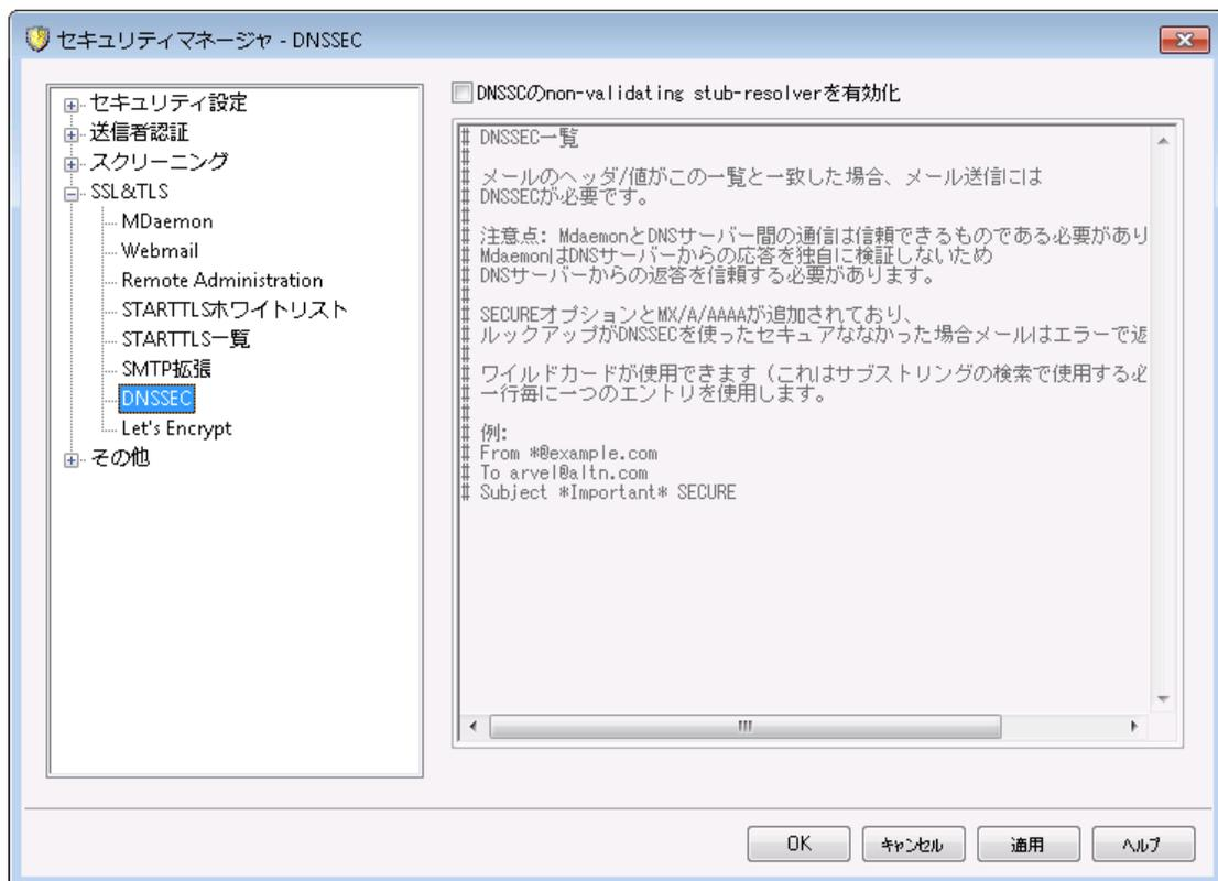
新しいDNSSEC (DNS Security Extensions) オプションで、MDaemonがRFCの [4033](#) と [4035](#) にて「DNSクエリの送信やDNS応答の受信、スタブリゾルバのサービスを提供できるDNSSEC対応ネームサーバーとの安全な通信の確立を行うエンティティ」と定義された、署名を検証しないDNSSEC対応スタブリゾルバとして動作できるようになります。これはMDaemonがDNSへの問合せを行う際DNSSECサービスをDNSサーバーへ要求し、AD (Authentic Data) ビットを使った問合せを行い、応答を確認できるようになるということです。DNSSECは現在全てのDNSサーバーが全てのトップレベルドメイン向けに対応しているものではありませんが、これによりDNS処理中に追加レベルのセキュリティを実装できるようになります。
