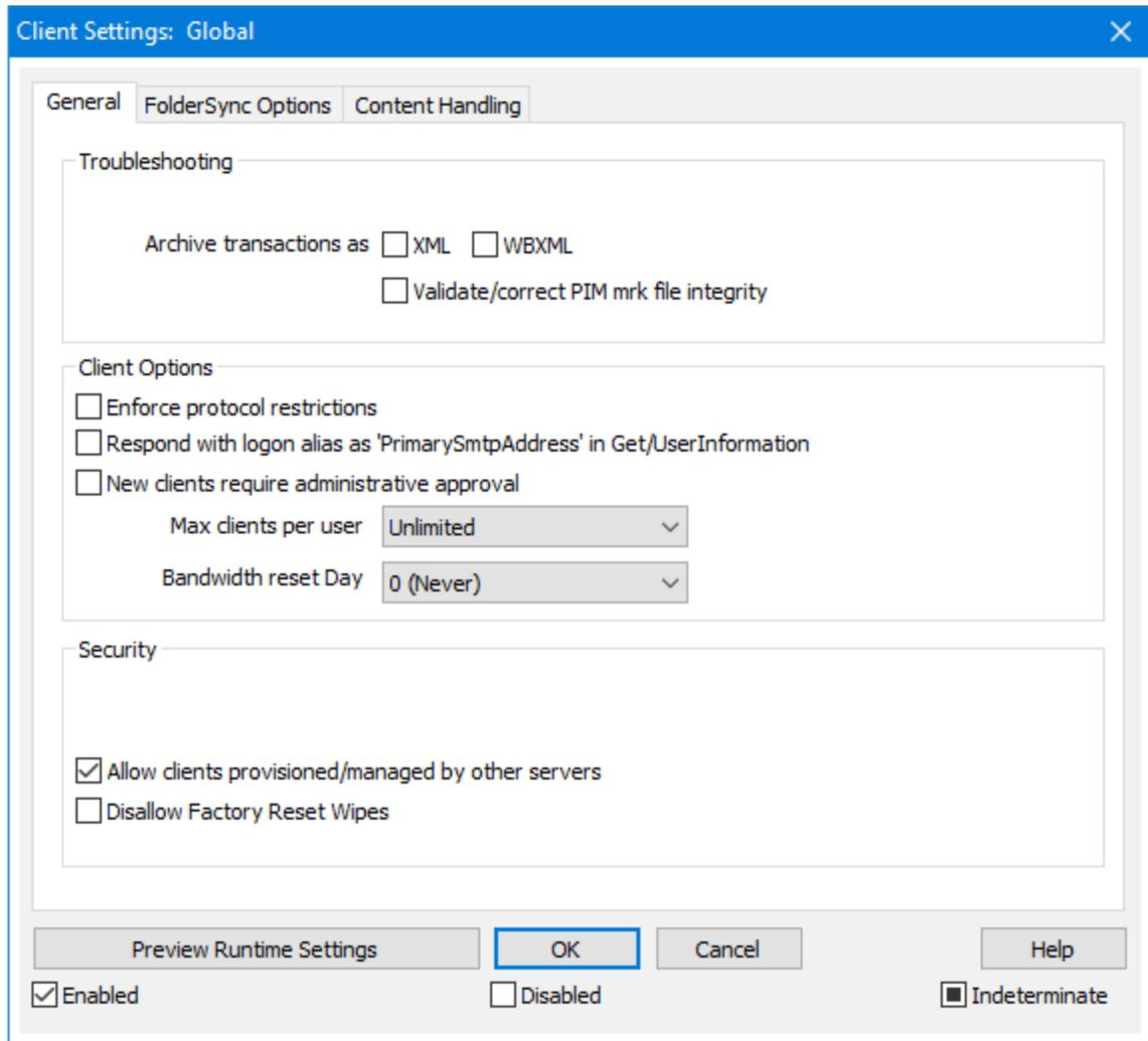
この画面ではActiveSyncクライアントを管理するための全体設定が行えます。これに対応したクライアント設定が、ActiveSyncの、[ドメイン](#)<sup>[391]</sup>、[アカウント](#)<sup>[407]</sup>、[クライアント](#)<sup>[416]</sup>、といった他のページにも存在します。全体設定で特定の値を設定すると、ドメイン、アカウント、クライアントのデフォルト値は上位のオプションを引き継ぎます。そのため、この画面で行った設定は、他の設定にも影響を与える事になります。この画面で設定を行う事により、下位のクライアント全ての設定を効率よく管理できます。また、ドメインやアカウント、それ以外の下位の設定は上位の設定値を上書きし、必要に応じてドメイン、アカウント、その他のレベルで設定変更が行えます。
