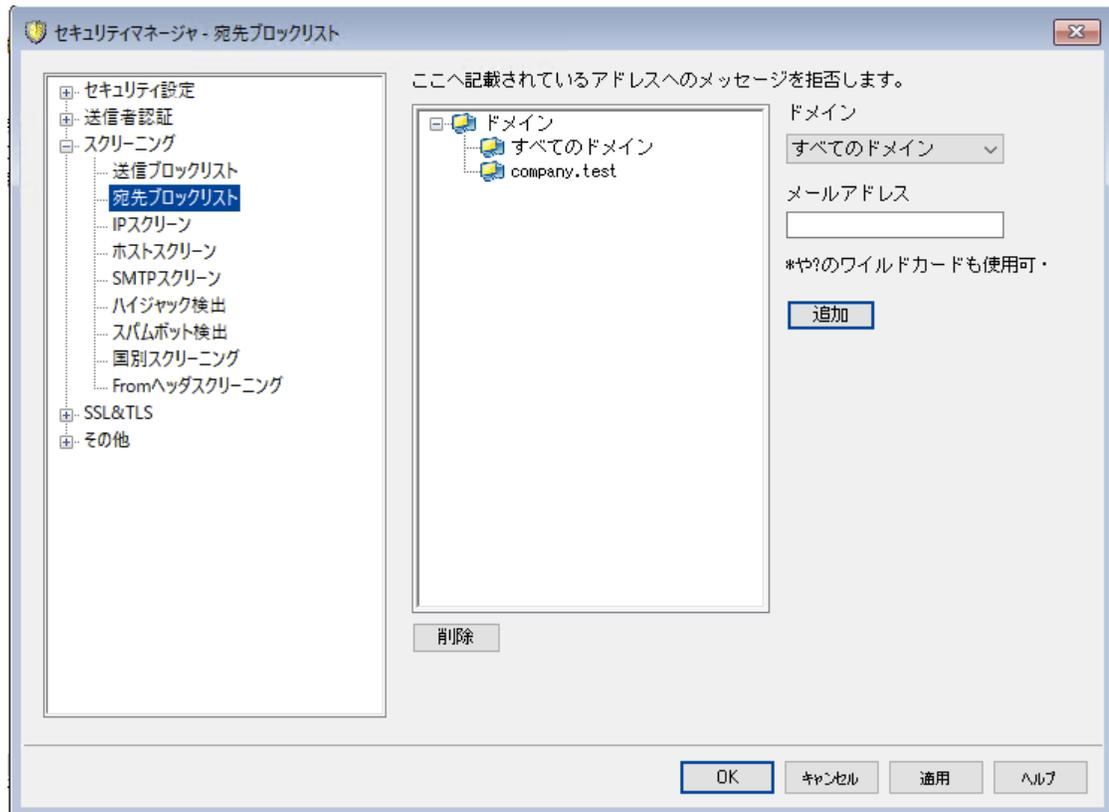
宛先ブロックリストは、セキュリティ » セキュリティ設定 » スクリーニングで表示できます。ここにはサーバーを通じてメール受信を許可していないアドレスを一覧で設定します。この一覧へ届いたメッセージは拒否されます。アドレスはドメイン毎か全体に対してブロックリスト化できます。宛先ブロックリストは（メッセージヘッダではなく）SMTP envelopeのRCPTデータのみを処理します。
