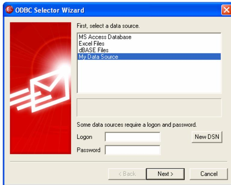
2. アカウントデータベースに使用するデータソースを選択してください。互換データソースがリストされていない場合、新しいDSNを選択し、[新規ODBCデータソース](#)に記載されている説明にしたがって、新しいデータソースを作成してください。
