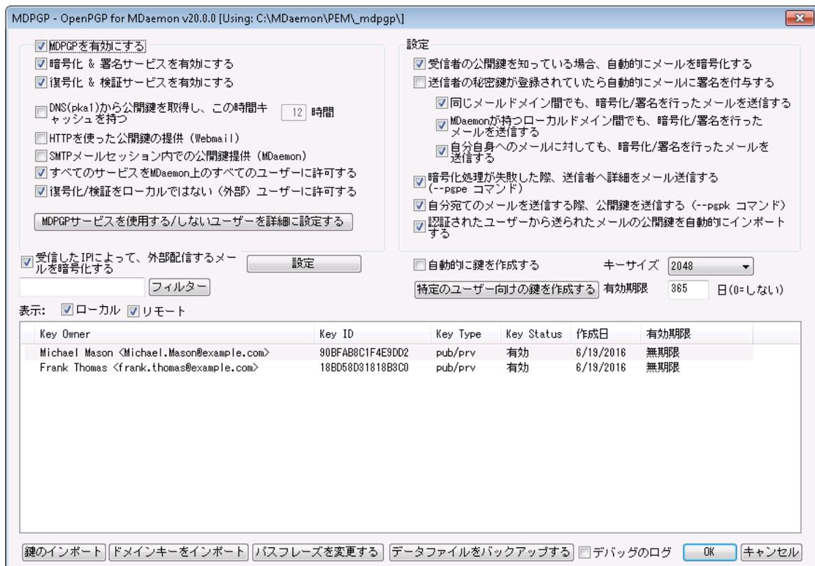
OpenPGPは暗号化されたデータをやり取りするための業界標準プロトコルで、ユーザーが暗号化メールを送受信できるよう、数々のメールクライアント用OpenPGPプラグインが存在しています。MDPGPIはMDaemonに搭載されたOpenPGPコンポーネントで、ユーザーはメールクライアント用プラグインを使わずとも、暗号化、復元、簡単な鍵管理が行えます。
