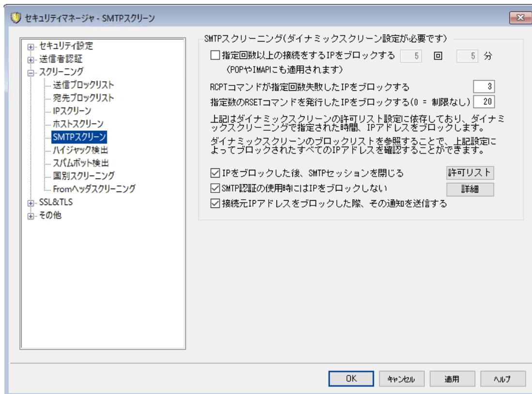
SMTPスクリーンを使うと、指定した分数の間で指定回数以上の認証失敗があったIPアドレスをブロックできるようになります。また、指定回数以上失敗したRCPTや、指定数以上のRSETコマンドの送信元もブロックできます。SMTPスクリーンにはダイナミックスクリーニングが必要で、[ダイナミックブロックリスト](#)<sup>571</sup>と[ダイナミック許可リスト](#)<sup>569</sup>を使用します。
