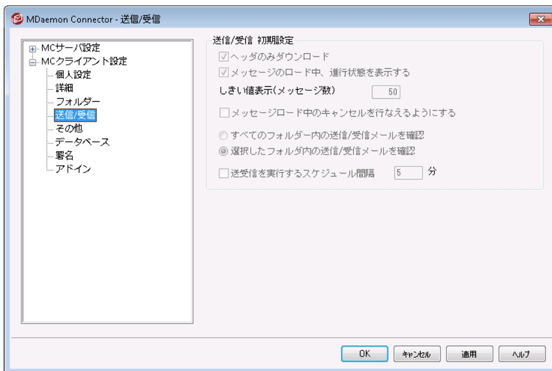
[MCクライアント設定](#) <sup>349</sup> 画面にある、「クライアント設定をMCユーザーへプッシュ配信する」オプションを有効化していると、MDaemon Connectorユーザーがサーバーへ接続する際、画面上の設定がMDaemon Connectorクライアントの関連する画面へプッシュ配信されます。MCクライアント設定は最後にクライアントが接続しデータを受け取ってから変更があった場合にのみ送信されます。
