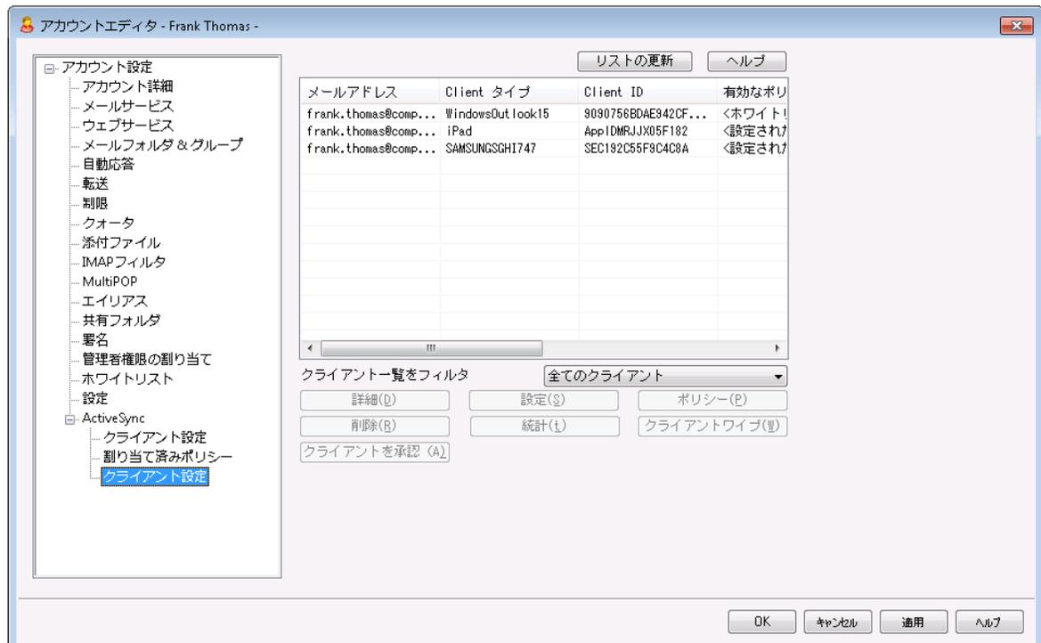
この画面ではユーザーアカウントと関連付けられたActiveSyncクライアントの情報が表示されています。ここから各クライアントに対するActiveSyncポリシー<sup>701</sup>の適用、様々なクライアント設定のコントロール、クライアントの削除、リモートワイプ、MDaemon内のクライアント統計情報の初期化などの処理が行えます。
