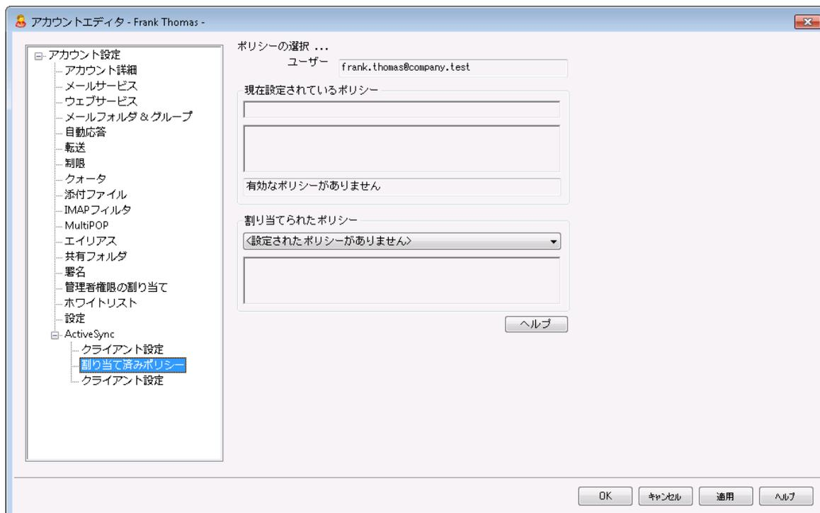
ここではActiveSyncクライアントがアカウントへの接続時に使用する、デフォルトのActiveSyncポリシー<sup>[399]</sup>を設定します。デフォルトでポリシー設定はドメインのポリシー<sup>[203]</sup>設定を引き継ぎますが、アカウント毎にここで設定を上書きする事ができます。更に、特定の異なるクライアント<sup>[702]</sup>へ割り当てたポリシーは、このアカウント毎の設定を上書きできます。
