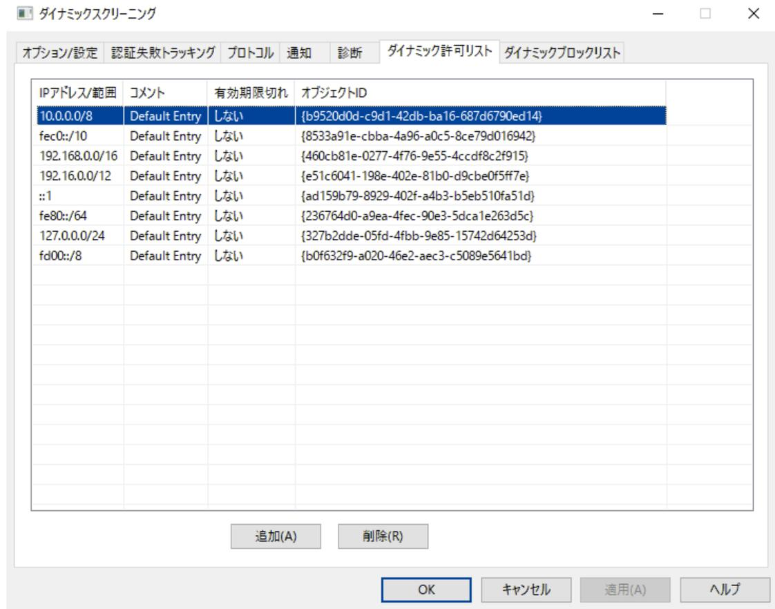
ダイナミック許可リストはMDaemonへ接続しようとした際ダイナミックスクリーニングサービスのブロック対象から除外するIPアドレスやアドレス範囲の一覧です。アドレスは追加ボタンから手動で追加することができます。各エントリはIPアドレス又は範囲とエントリの期限日時(「なし」を設定すると無期限となります)、エントリに追加するコメント、オブジェクトIDから構成されています。ダイナミック除外リストは[SMTPスクリーン](#) <sup>[516]</sup>、[ロケーションスクリーニング](#) <sup>[522]</sup>、[ターピッティング](#) <sup>[549]</sup>でも使用されます。
