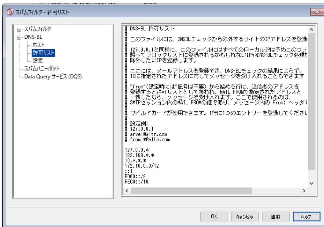
この画面では、DNSブロックリスト検索から除外するIPアドレスを指定できます。DNS-BLがローカルユーザーからのメールを拒否しないよう、(例えば127.0.0.\*、192.168.\*.\* などの)ローカルIP範囲やドメインを入力して下さい。ここではメールアドレスを指定する事もできます。このリストに対して送信したメールはDNS-BLルックアップ結果によらず受信する事ができます。最後に、「from sender@example.com」を一覧に追加入力する事で、特定の送信者をDNS-BL結果から除外する事もできます。アドレスはメールの「From:」ヘッダではなくSMTPセッションの「MAIL FROM」の値に一致している必要があります。
