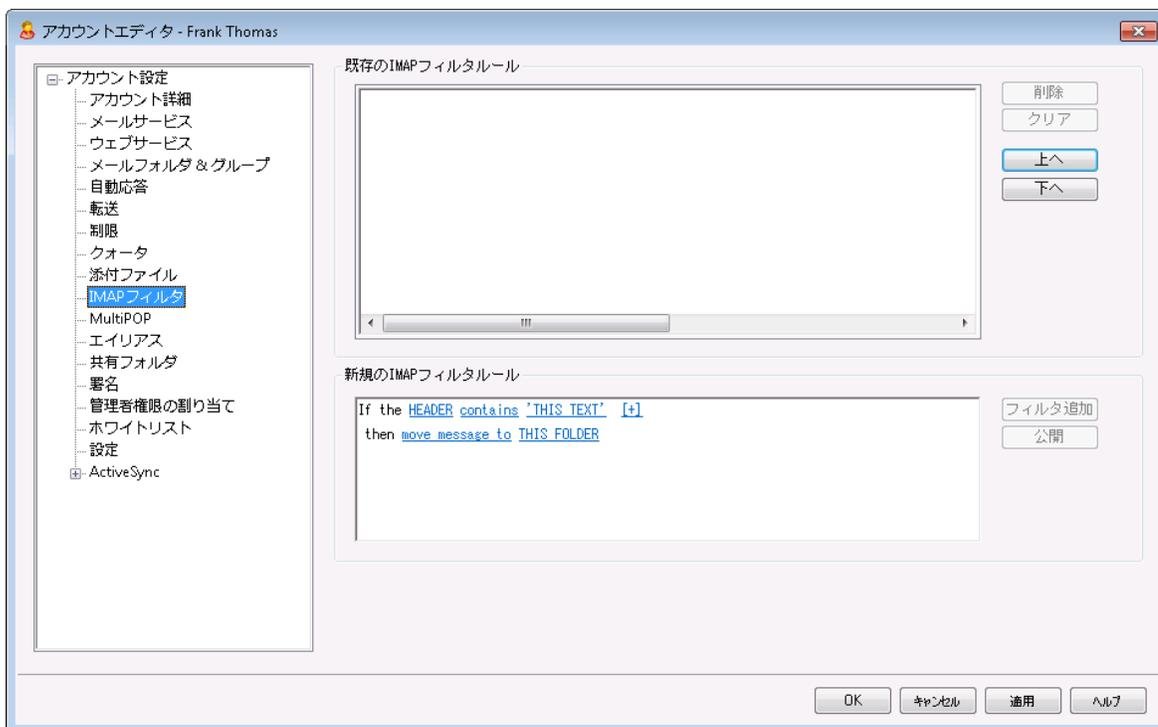
IMAPやWebmail<sup>284</sup>ユーザは、フィルタを使って特定のメールを自動振り分けすることができます。コンテンツフィルタ<sup>588</sup>と同様に、MDaemonは受信メールのヘッダに記載されたドメインを、フィルタルールと比較します。アカウントへのメールが、それらの規則の1つと一致すると、その規則で指定されるフォルダに振り分けられます。この方法は、クライアント側でメッセージをフィルタにかけるよりも(クライアントとサーバの両方にとって)はるかに効率的です。IMAPメールの中にはローカルメール規則やフィルタリング機能さえないものがある中で、MDaemonではこのような機能も提供が可能です。
