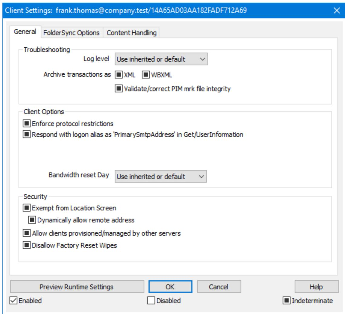
デフォルトでこの画面の全てのオプションは「継承又はデフォルト」と設定されており、各オプションが [Clientタイプクライアント設定](#) <sup>[432]</sup>の関連オプションの設定を継承します。同様に、この画面で行った設定変更はデバイスのクライアントレベル設定を上書きします。
