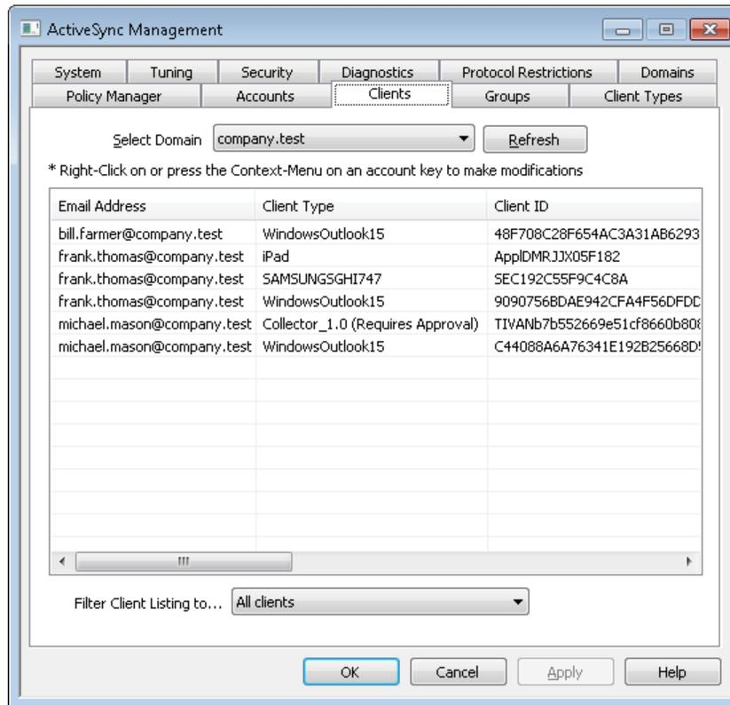
ここへはドメインと関連付けされたActiveSyncクライアントが一覧表示されます。詳細を確認するには対象のエントリをダブルクリックして下さい。右クリックするとショートカットメニューが表示され、クライアント設定のカスタマイズや統計情報の表示、その他機能を使用できます。
