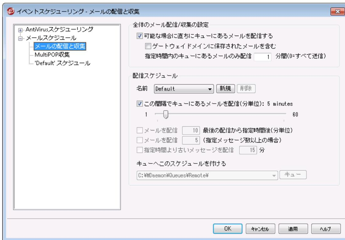
設定 » イベントスケジューリングから、MDaemonのイベントスケジューラを開きます。このダイアログから、MDaemonのリモートメール処理イベントを、詳細にも、シンプルにも、お好きな方法でスケジュールすることができます。[メールスケジュール](#)<sup>[344]</sup>で、メールの配信と収集の時間を、正確にスケジュールすることができます。一定の間隔でメールを処理するためにカウンタを使用することができます。また、スケジュールではなく、例えば一定の数のメールが溜まった場合や、配信待ち時間が指定した時間に到達した場合、といったトリガーで、メールの処理を行わせる事もできます。さらに、カスタムリモートメールキューへカスタムスケジュールを割り振る事もできます。カスタムスケジュールによって、様々なタイプのメッセージに対して異なるスケジュールを設定することができます。例えば、サイズの大きなメッセージやメーリングリストのメッセージ、特定のドメインなどに対してそれぞれのスケジュールを作成することができます。
