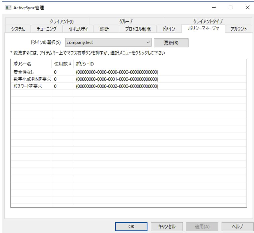
ここではユーザーのデバイスに適用するActiveSyncポリシーに関する様々な設定を行います。定義済ポリシーが提供されており、独自のポリシーの作成や編集、削除もここで行えます。デフォルトポリシーはドメイン毎<sup>39)</sup>やアカウント毎<sup>40)</sup>に適用され、特定のクライアント<sup>213)</sup>へも適用できます。
