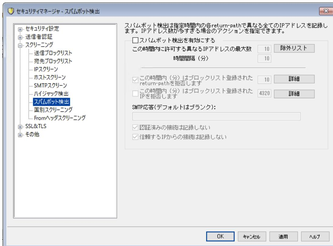
スパムボット検出は、一定期間の間に使われた、全てのSMTP MAIL (return-path)の値を記録する機能です。短時間の間に複数のIPアドレス(端末の切り替えで複数になる事があります)で同じreturn-pathを使っていた場合、スパムボットネットワークである場合があります。スパムボットが検出されると、その時点での接続はすぐに遮断され、必要に応じてreturn-pathの値を指定した時間ブロックリストとして登録する事もできます。また、ユーザーが定義した期間、全てのスパムボットIPをブロックリストへ登録する事もできます。
