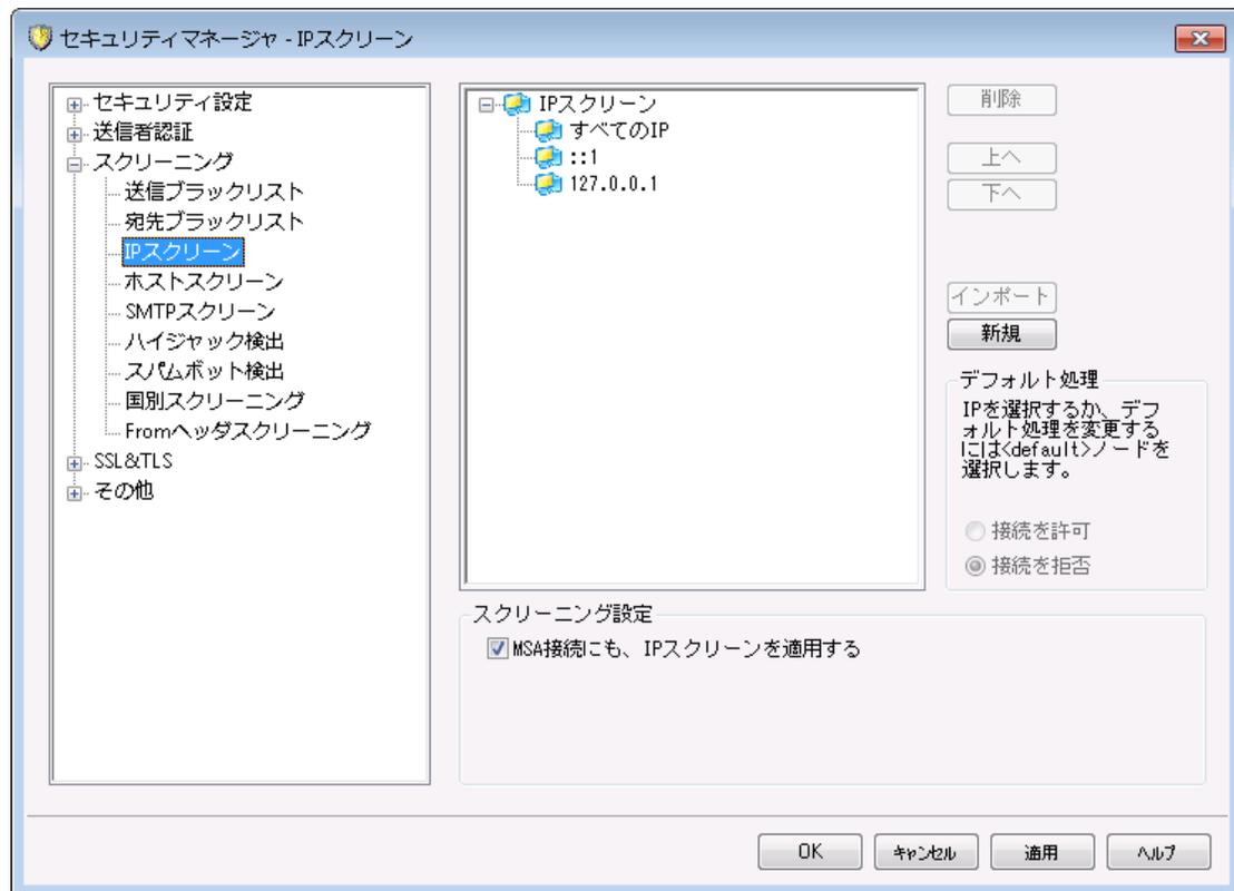
IPスクリーンは、セキュリティ » セキュリティ設定 » スクリーニングで表示できます。IPスクリーンは、ローカルIPアドレスに対して接続を許可するIPと接続を許可しないIPを指定するのに使用します。IPスクリーンで指定するIPアドレスは、ローカルアドレス全てを指定する事も、個々のIPを指定する事もできます。CIDR表記法およびワイルドカード\*、#、and ?が使用できます。
