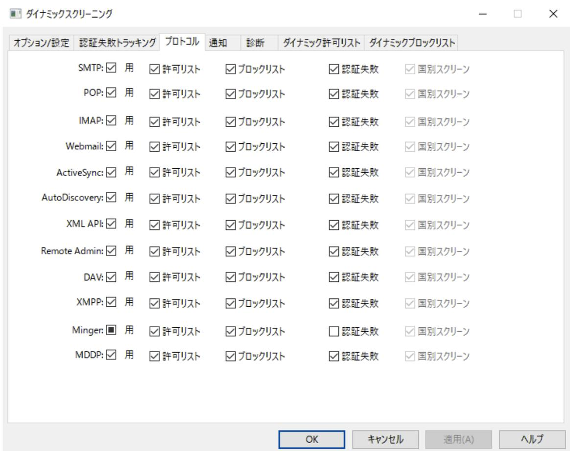
デフォルトでは、ダイナミックスクリーニングサービスはSMTP、POP、IMAP、Webmail、ActiveSync、[AutoDiscovery](#)<sup>[56]</sup>、管理API、MDaemonリモート管理。WebDAVとCalDAV、XMPP、およびMingerプロトコルに適用されます。プロトコルタブでは、インバウンドセッションにおける[ダイナミック除外リスト](#)<sup>[569]</sup>や[ダイナミックブロックリスト](#)<sup>[571]</sup>のチェックや[国別スクリーニング](#)<sup>[522]</sup>が適用された[認証失敗のログ](#)<sup>[560]</sup>の対象とするプロトコルを選択できます。デフォルトでは、このダイアログのすべてのオプションはMinger認証失敗を除いて有効になっています。
