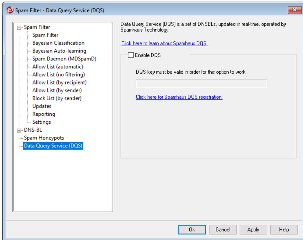
Data Query サービス (DQS) DNSBL<sup>[638]</sup> のセットで、Spamhaus Technologiesによってリアルタイムに更新され、99%のメールの脅威をブロックする事ができると言われています。DQSを使用するには、Spamhaus Technologyが発行するサブスクリプションキーが必要です。DQSサービスを使用するには、次の手順で設定を行います。
