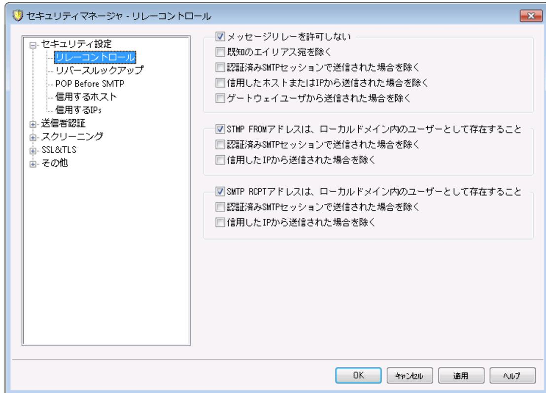
セキュリティ » セキュリティ設定 » リレーコントロールメニューから、メールリレーをどのように処理するかを設定することができます。ローカルアドレスからでもなく、ローカルアドレス宛でもないメールがサーバーに届くと、メールは他のサーバーへリレー（配送）するよう要求されます。知らないユーザー宛のメール配信を行いたくない場合、ここで設定を行って下さい。
