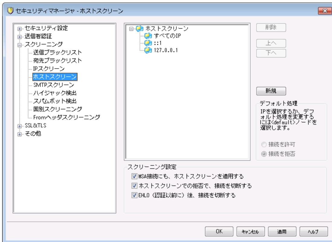
ホストスクリーン設定画面は、セキュリティ » セキュリティ設定 » スクリーニングから接続できます。ホストスクリーンは、ご使用になられているローカルIPアドレスに接続できるリモートホストを定義するのに使われます。この機能により、特定のホストからだけ接続を許可する、もしくは特定のホストからの接続を拒否するといった設定が可能になります。ホストスクリーンでは、SMTPセッション内で使用されるEHLOとPTRでの値とここで指定したリスト内の値を比較します。
