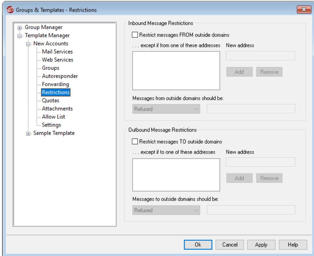
このテンプレート画面のオプションは、アカウントエディタの**制限**<sup>[664]</sup>画面のオプションに対応しています。テンプレートで**この画面をコントロール**<sup>[722]</sup>するよう設定していると、**グループ**<sup>[713]</sup>に所属している全アカウントの制限オプションはテンプレートの設定値を継承します。
