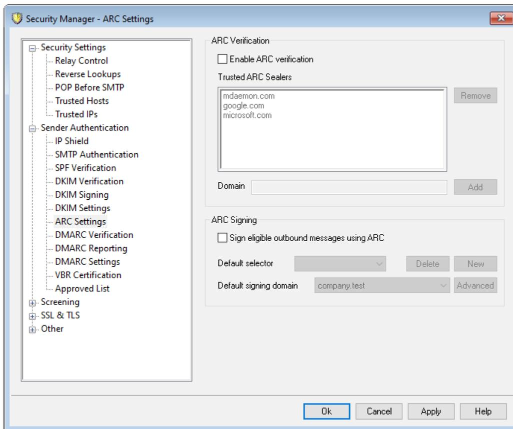
Authenticated Received Chain (ARC) とは、メールの認証評価へ中継メールサーバが署名するメール認証プロトコルです。これにより、「保護の連鎖」が認証され、各サーバがメールの処理を行う際、前のサーバがどのように処理を行ったか、各ステップで認証が成功したかどうかの確認が行えます。下流のメールサーバがDMARC検証を行い、SPFやDKIMが(例えば転送やメーリングリストの変更などで)認証に失敗した場合、信頼するホストのARC結果を確認し、メールを受け入れるかどうかを判断できます。認証するかどうかを判断する事ができます。
