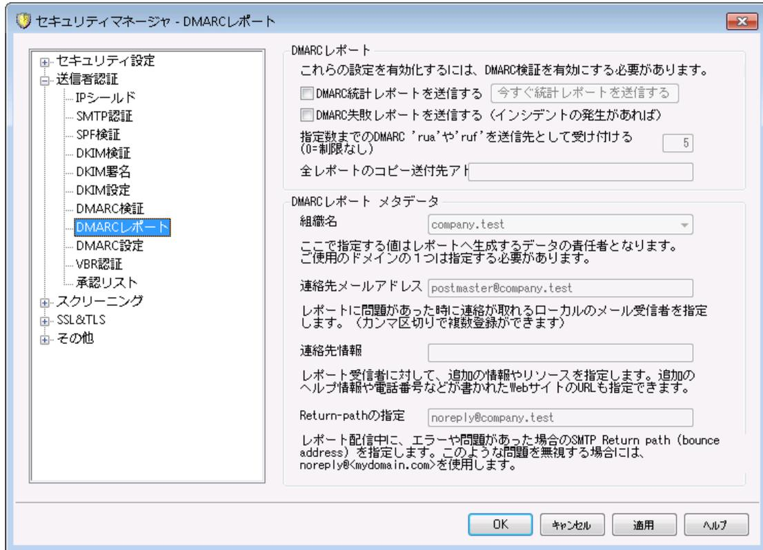
MDaemonがDNSへDMARCLレコードの問合せを行った際、DMARCLレコードに、対象ドメイン所有者が、そのドメインを名乗ったメールをレポートとして提供するように求めるタグが含まれている場合があります。DMARCLレポートのオプションでは、要求されている統計又は失敗レポートを送信するかどうかや、レポートに追加するメタ情報の指定を行う事ができます。この画面にあるオプションは、[DMARCL検証](#)<sup>[496]</sup>でDMARCL検証とレポートを有効にする オプションが有効化されている場合にのみ利用できます。また、DMARCLの仕様によると、レポートの宛先サーバーが対応していれば、レポート送信には[STARTTLS](#)<sup>[526]</sup>を使用する必要があります。STARTTLSを可能な限り有効化して下さい。
