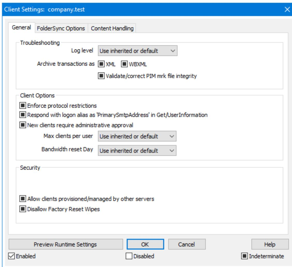
デフォルトでこの画面の全てのオプションは「継承又はデフォルト」と設定されており、各オプションが[アカウントのクライアント設定](#)<sup>[407]</sup>の関連オプションの設定を継承し、設定変更した場合はこの画面へ反映されます。同様に、ドメインの[アカウント](#)<sup>[407]</sup>設定は、この画面で行った設定を継承します。その後も、クライアントタイプは設定をアカウントレベルの設定から継承し、最終的には個々の[クライアント](#)<sup>[416]</sup>が自身の設定値を保持する事になります。この設定でドメインのアカウントとクライアント全体の設定を、この画面から設定を行うだけで変更することができるようになり、必要に応じて全てのアカウントやクライアント設定を上書きできるようになります。
