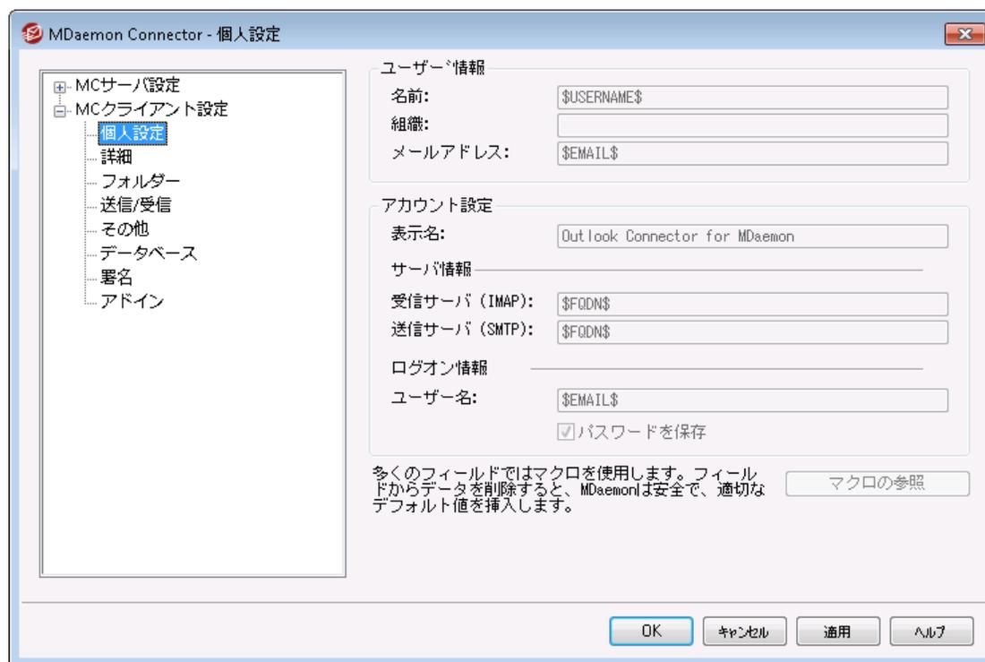
**MC クライアント設定** [\[349\]](#) 画面で「MCユーザーへクライアント設定をプッシュ配信する」オプションを有効化していた場合、MDaemon Connectorが次回サーバーへ接続した際、この画面の設定が対象のMDaemon Connectorクライアント画面の設定を上書きします。MCクライアント設定は最後にクライアントが接続した際に受信した設定値から変更があった場合にのみ更新されます。この画面のほとんどの項目は、固定値ではなくマクロを含んでいます。後述の **マクロの参照** [\[352\]](#) をご覧ください。
