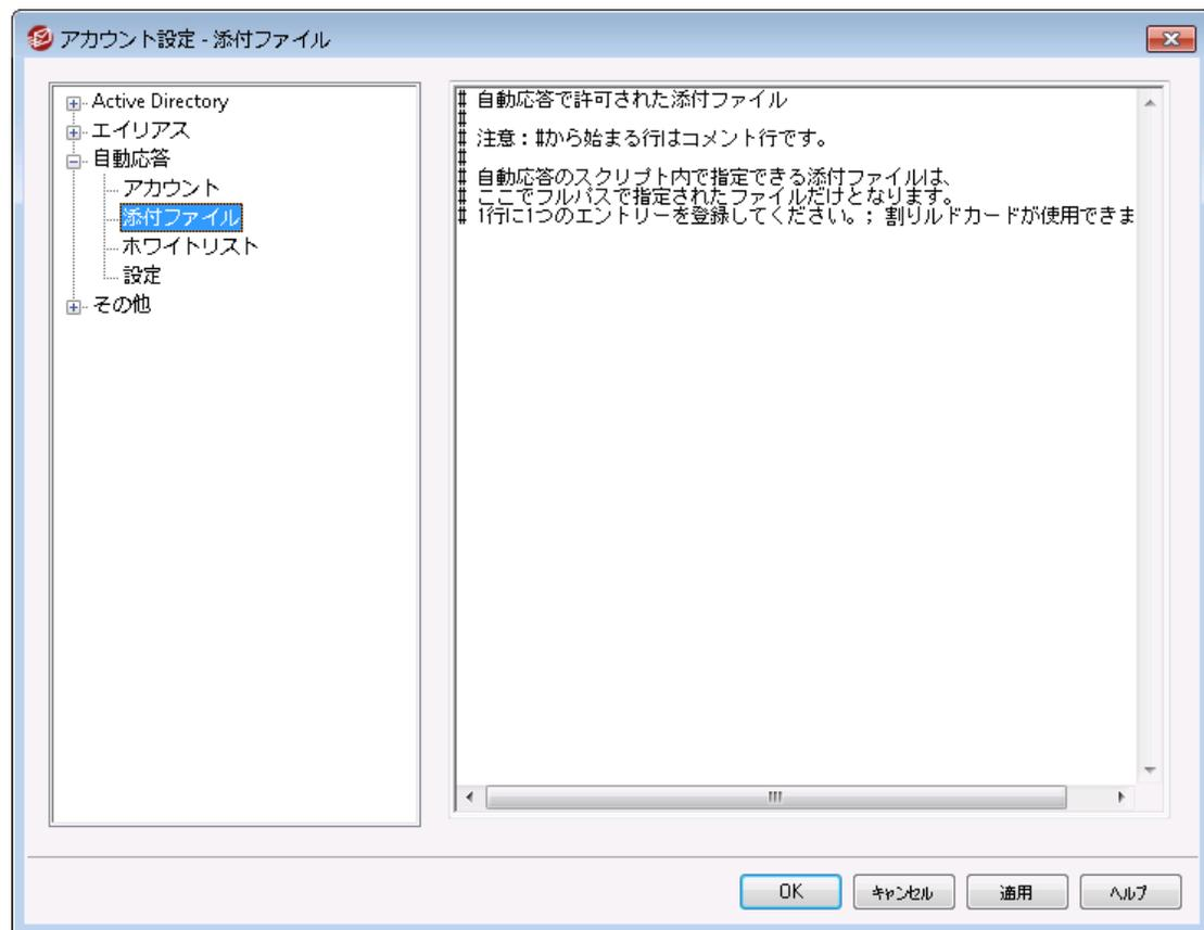
[自動応答スクリプト](#) <sup>768</sup> の添付ファイルとして使用するファイルのフルパスをここで指定します。自動応答スクリプト内の **%SetAttachment%** マクロが添付ファイル名へ差し替えられます。
