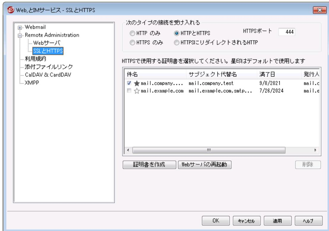
MDaemonに搭載されているウェブサーバーはSecure Sockets Layer (SSL)プロトコルに対応しています。SSLとは、サーバー/クライアント間のウェブコミュニケーションを安全に行うための標準規格であり、
