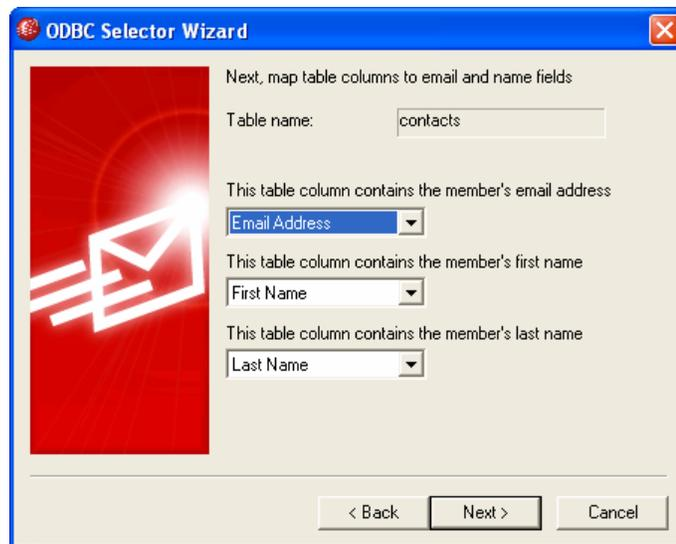
7. ODBC選択ウィザードは、手順6で選択した内容に基づいてSQLステートメントを構成します。MDaemonは、それを使用してデータベースから標準メーリングリストメンバーのデータを検索します。メンバーにダイジェストモードでメールの受信またはメンバーを受信専用あるいは投稿専用として指定するためにこのステートメントを編集、残りのコントロールで他のクエリステートメントを指定することができます。各コントロールの横にあるテストボタンで、クエリステートメントが適切なデータを検索するかどうかを確認することができます。クエリのステートメントの構成が完了したら次へボタンをクリックします。
