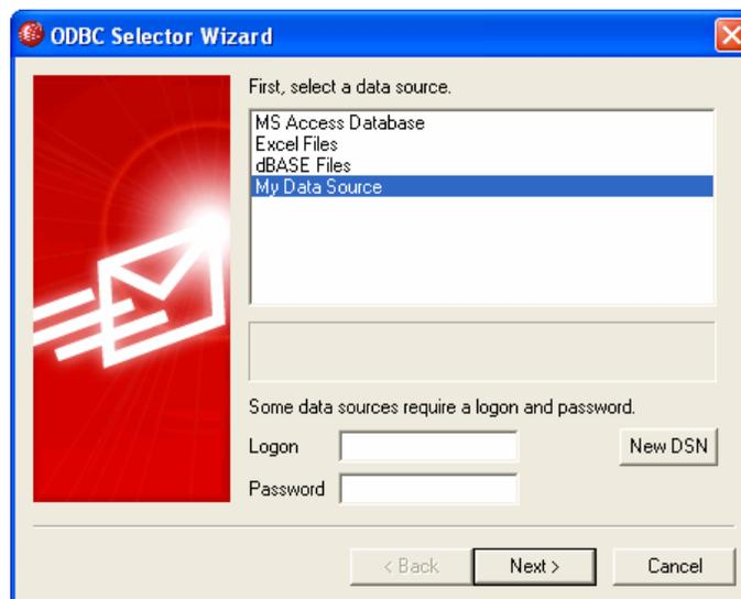
2. リストで使用するデータソースを選択します。データソースがない場合は、新しいDSNをクリックし [新規ODBCデータソースの作成](#) <sup>[272]</sup> 指示に従いデータソースを作成します。
