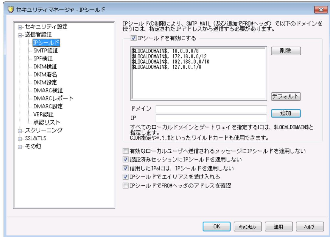
セキュリティ » セキュリティ設定 » 送信者認証の中にあるIPシールドとは、SMTPセッション中に、MAIL Fromコマンドで渡されるドメインとそれに紐づいたIPアドレスの一覧です。対象ドメインからのSMTPセッションは、正しく関連付けられたIPアドレスからの接続である場合のみ有効とされます。例えば、ドメイン名が[example.com]で、ローカルLANで使用されているIPが[192.168.0.0]から[192.168.0.255]の範囲とします。このような場合、IPシールディングに設定するドメイン名は[example.com]で、そのドメインに関連付けするIPアドレス範囲として[192.168.0.\*]を指定することができます(ワイルドカードが可能です)。その結果、コンピュータがSMTPサーバに接続し、“MAIL FROM <someone@example.com>”を要求する場合、SMTPセッションでは接続を要求しているコンピュータが指定したIPアドレス範囲(この場合は[192.168.0.0]から[192.168.0.255]まで)を持つ場合のみ継続されます。
